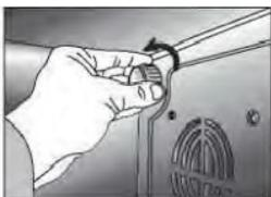
**AVVERTENZA:** Per evitare scosse elettriche, assicurarsi che il circuito del dispositivo sia aperto prima di cambiare la lampada. (Circuito aperto significa che l'alimentazione è interrotta.)
